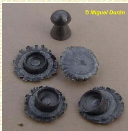
(Balines recuperados al pie de la plancha metálica)
