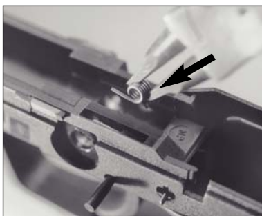
Fig. 26: Incorporación del muelle con patas
