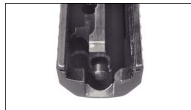
Fig. 17: Posición del percutor
