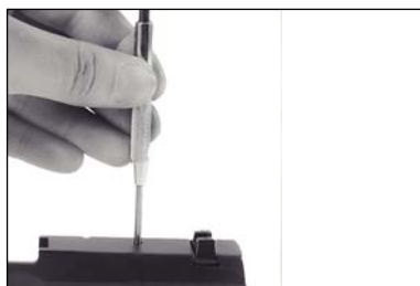
Fig. 13: Expulsión del pasador elástico
