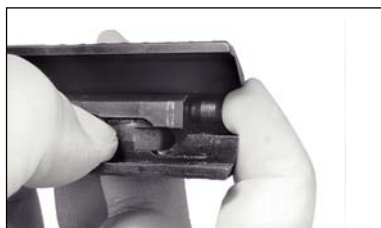
Fig. 15: Retirada del percutor y del resorte de compresión
