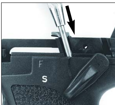
Fig. 19: Presionar hacia abajo el empujador
