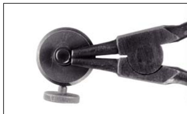
Fig. 22: Desmontaje del anillo de muelle (23)
