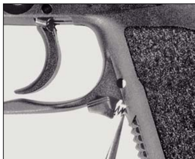
Fig. 31: Presionar hacia arriba el resorte de compresión
