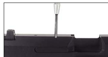
Fig. 11: Expulsión del pasador elástico
