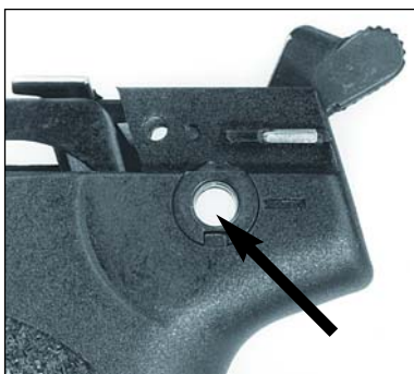
Fig. 20: Desplazar hacia arriba el empujador
