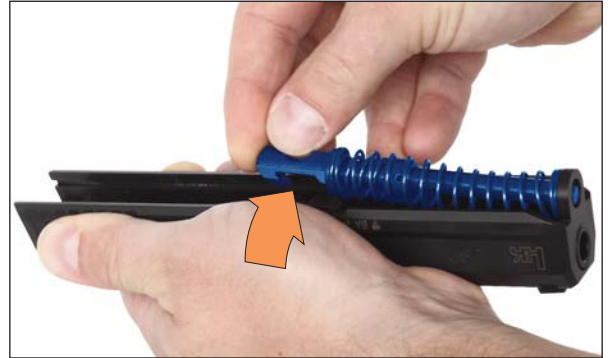
Fig. 38b: Sacar el resorte recuperador
