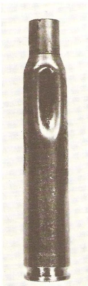
*Un curioso fenómeno de hundimiento en una 7 x 64. Este incidente tiene su origen en una mala inflamación de la pólvora, principalmente de los tipos esferoidales. Obsérvense los granos no quemados pegados al fondo de la cavidad.*
