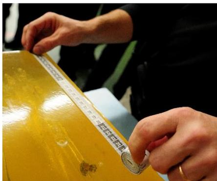
2. Inspección de cavidades permanentes mediante inyección de agua tintada en el canal de la herida balística.
