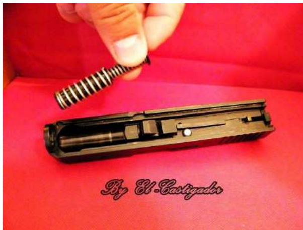
Extracción del muelle recuperador de la corredera
