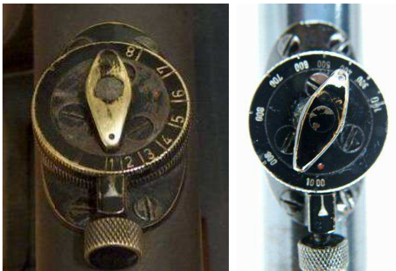
A gauche, réglage de la distance de tir sur une lunette Zielvier (1 – 8) et à droite, sur une lunette Zielsechs (100 – 1000)
