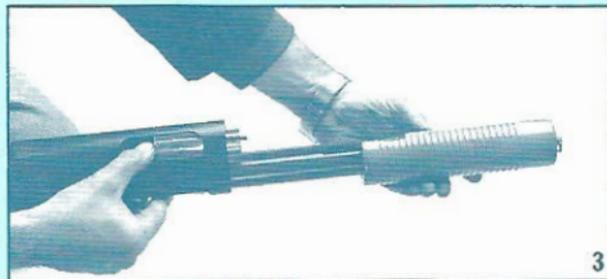
c) Montar el cañón, cuidando que el anillo quede perfectamente ajustado sobre el tubo-depósito (Fig. 4).
