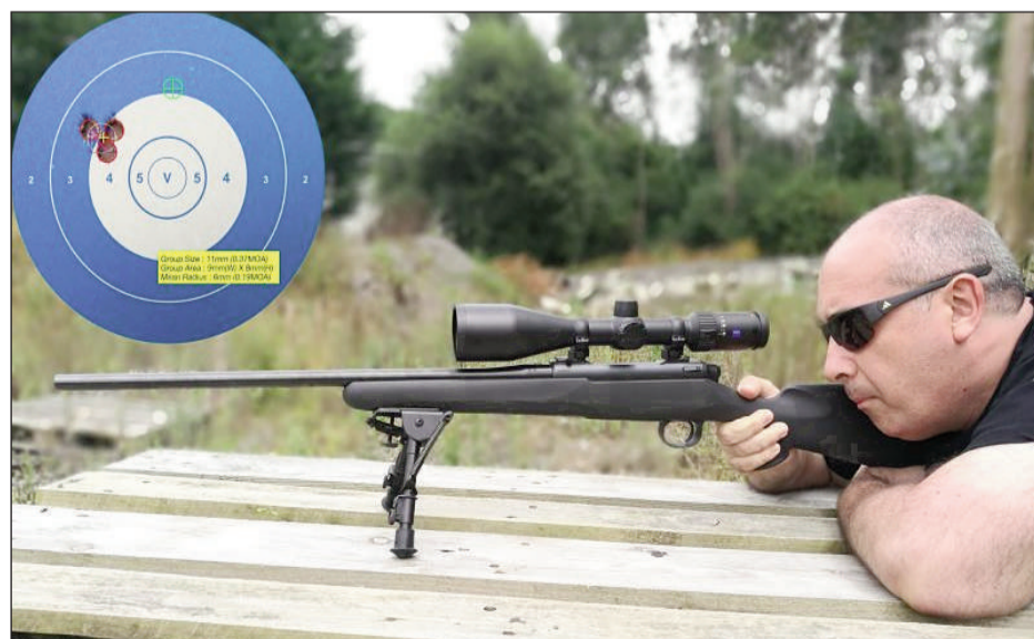
Disparando el Mauser M18 obtuvimos con munición NORMA una mejor diana de 0,37 MOAs
