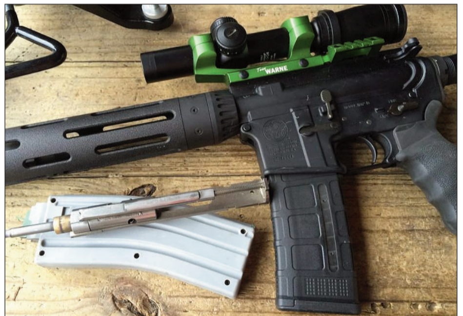
Son dos las opciones para transformar un AR-15 en una carabina del .22 LR
