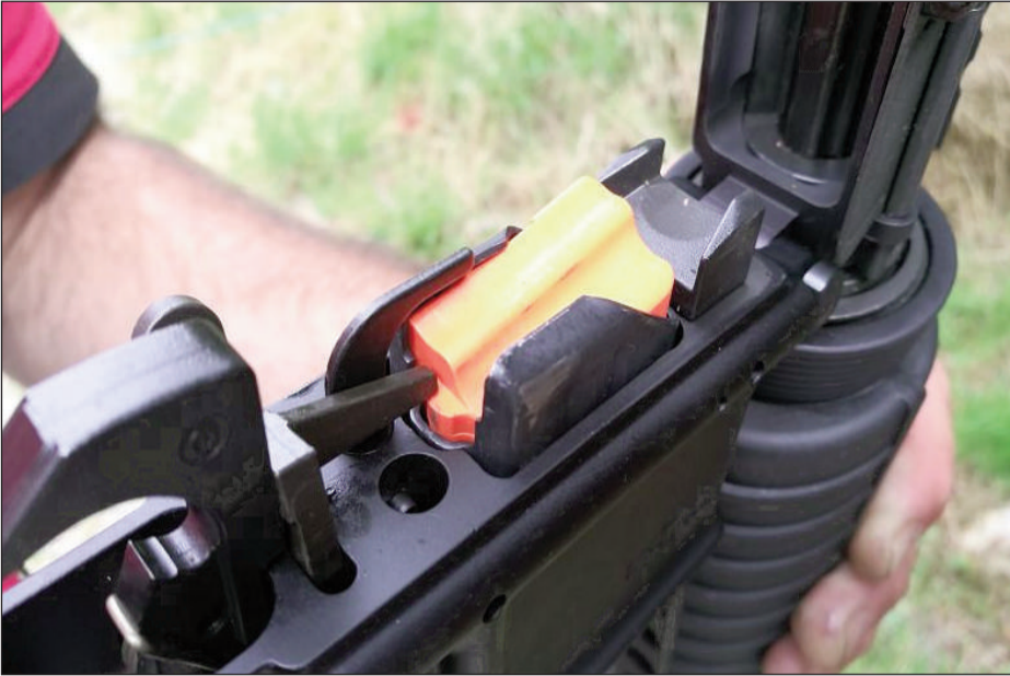
Detalle del martillo específico y rampa a la recámara
