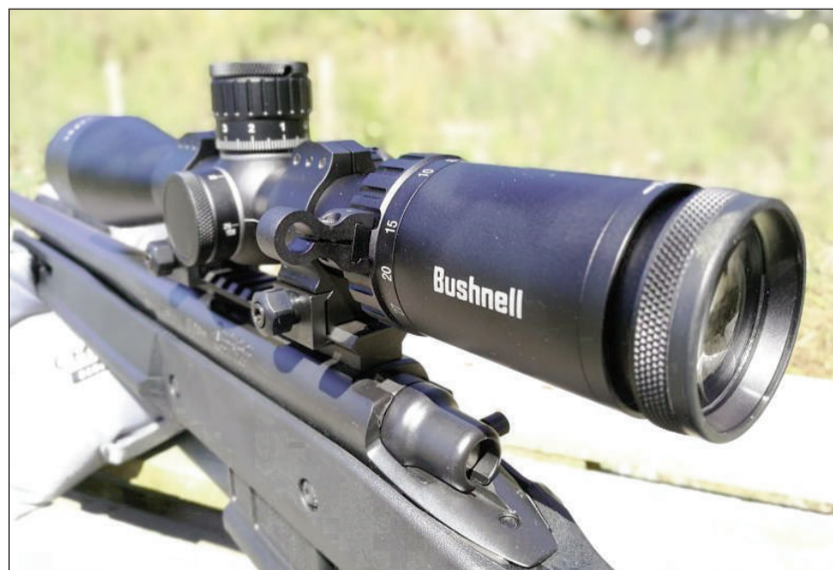
El anillo de magnificación trae de serie una maneta atornillada
