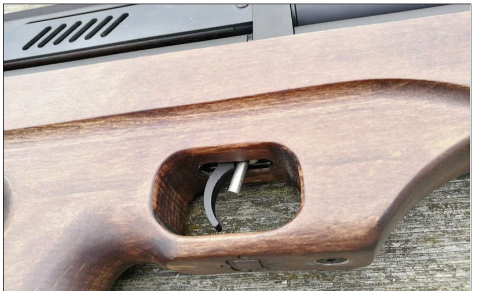
Detalle del disparador con el seguro activado
