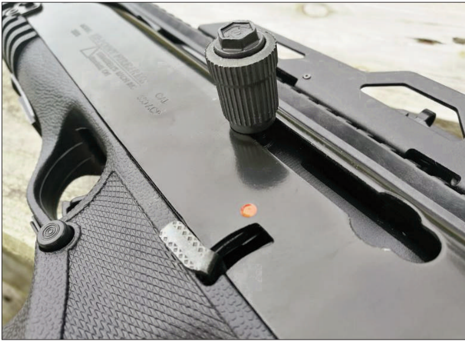
Detalle del tirador del cerrojo y palanca de seguro
